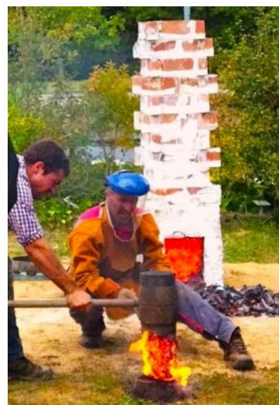
Cinglage à l'enclume de la loupe de fer, juste sortie du bas fourneau, en arrière plan. Photo J Luc Herpin
