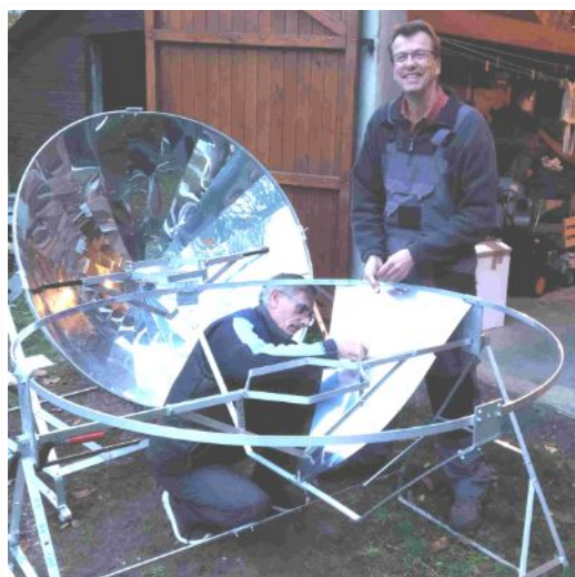
L'assemblage des 24 miroirs en tôle d'aluminium anodisée demande un peu de patience et de temps pour visser les 48 petits boulons.
