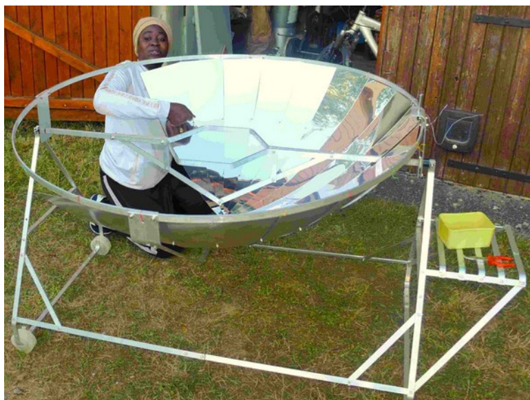
L'assemblage des 24 miroirs en tôle d'aluminium anodisée demande un peu de patience et de temps pour visser les 48 petits boulons.
