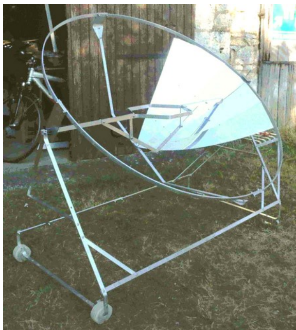
La structure est en profilé plat d'alliage d'aluminium, sans soudure, Seulement assemblée par 50 boulons.
