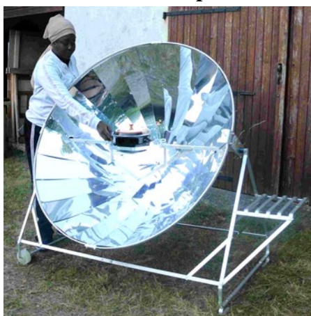
La structure est en profilé plat d'alliage d'aluminium, sans soudure, Seulement assemblée par 50 boulons.
