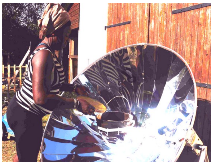
L'assemblage des 24 miroirs en tôle d'aluminium anodisée demande un peu de patience et de temps pour visser les 48 petits boulons.
