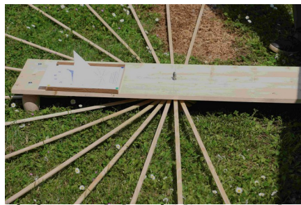
Vérification de la méridienne (Nord/Sud) avec la boussole solaire
