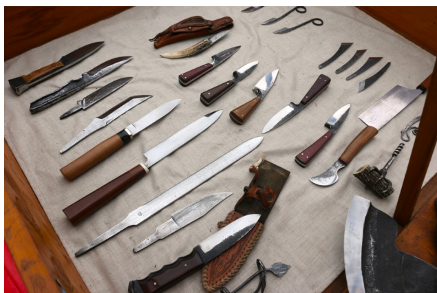
Couteaux à lame d'acier et manche bois, lames forgées à la main Bernard Lucas
