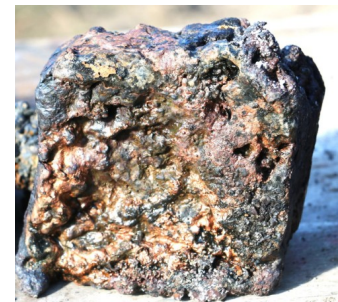
Belle loupe de fer de 6kg 200 optenue dans le bas fourneau le vendredi en présence des élèves
