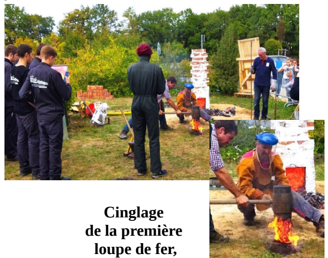
Belle loupe de fer de 6kg 200 optenue dans le bas fourneau le vendredi en présence des élèves
